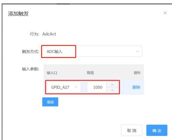
ADC 触发主要用途为通过不同的电压输入来模拟多按键，0 至 3.3V 对应取值为 0 至 4096，偏差为允许取值附近的上下范围（偏差在 PIN 配置中设置），当实际取值与设定取值的差的绝对值在偏差范围内时，会触发该行为。为了便于填写 ADC 触发的取值，平台允许通过播放语音，将 ADC 取值播放出来，这也可以作为确定 ADC 取值的调试手段，具体可参见手册
