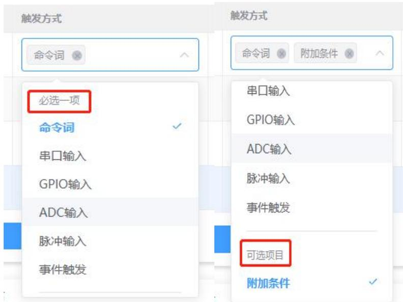
行为的触发方式包括必选项目和可选项目，必选项目为主触发方式，只能选一种，可选项目目前只有“附加条件”，用于实现行为的有条件触发。
