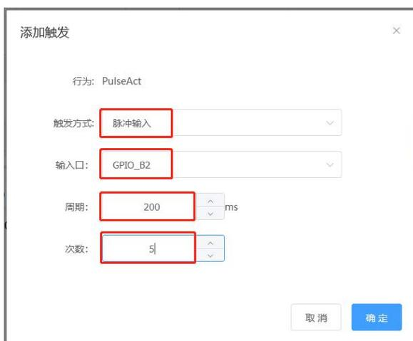
通过检测 GPIO 口的脉冲输入，当检测到脉冲周期与设定取值的差的绝对值在偏差范围内时（偏差在 PIN 配置中设置），如果达到设定的脉冲次数，会触发该行为。目前对脉冲周期的检测精度不高，为了通过触发的准确性，建议将输入脉冲的周期设置在 100 毫秒以上，如果有多个脉冲输入触发的行为，各个行为的输入脉冲周期需要设置为间隔 100 毫秒以上。
