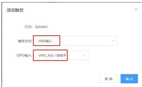
如果选择“低电平”，则行为会在 GPIO 口从高电平切换到低电平时触发；如果选择“高电平”，则行为会在 GPIO 口从低电平切换到高电平时触发。如果 GPIO 口的电平没有发生切换，则不会触发该行为。平台生成的固件中，会过滤掉 20 毫秒内的电平抖动，也就是说，如果电平切换后在 20 毫秒内又切换回来，将不会触发该行为。
