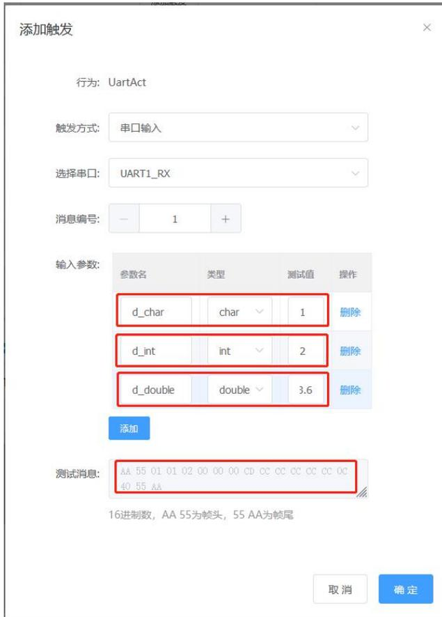
串口参数类型支持 char、int、double、unsigned char 四种类型，添加参数时，测试消息也会同步变化，char 类型和 unsigned char 类型参数占 1 个字节，int 类型参数占 4 个字节，double 类型参数占 8 个字节，具体编码方式可以参见生成固件包中 uart 目录下的 c 代码文件。
