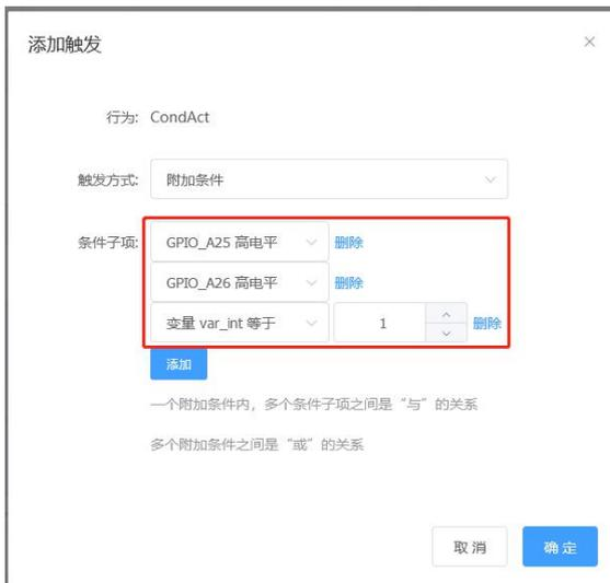
条件子项支持使用 GPIO 端口的状态和变量的状态，一个附加条件支持添加多个“条件子项”，多个条件子项之间是“与”的关系，需要同时满足条件子项的要求，行为才能触发后执行。一个行为也支持添加多个“附加条件”，多个附加条件之间是“或”的关系，只要有一个附加条件得到满足，行为就会触发执行。
