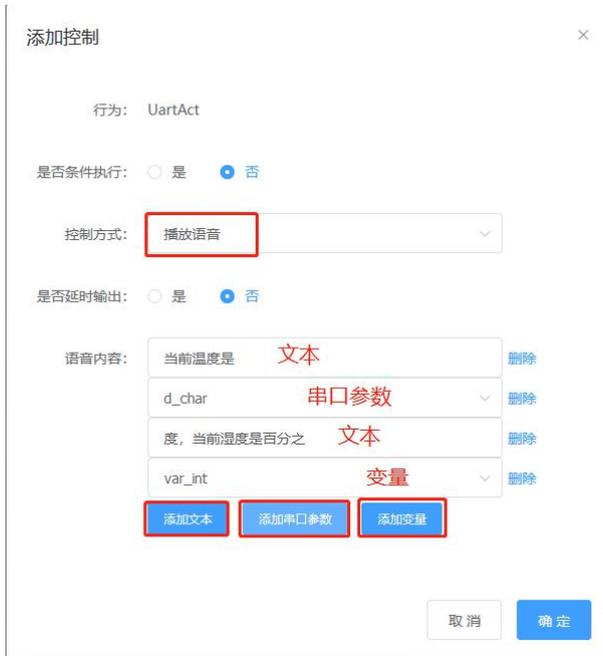
可以播放固定文本的语音，也可以播放数值型的可变语音。如果在一个串口触发的行为中，串口输入带有参数，则播放语音中可以选择串口参数进行播报；如果在变量定义中定义了变量，则播放语音中也可以选择变量进行播报。为了方便 ADC 触发和脉冲触发方式的调试，也可以在“添加变量”中，选择播放 ADC 基础值和脉冲检测值：
